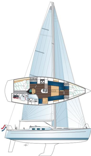
Sehr schiffige Form. Der große tiefe Kiel sorgt für hohe Stabilität. Ein Modell mit variablem Tiefgang ist geplant
