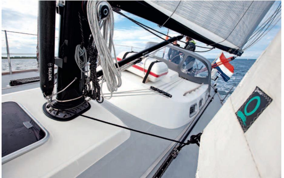
*Eine echte KOOPMANS: flaches Vordeck, schöne Linien, Fallen am Mast. Der Graben zwischen Kajütaufbau und Mastfuß sorgt für SICHEREN STAND bei Segelmanövern*
